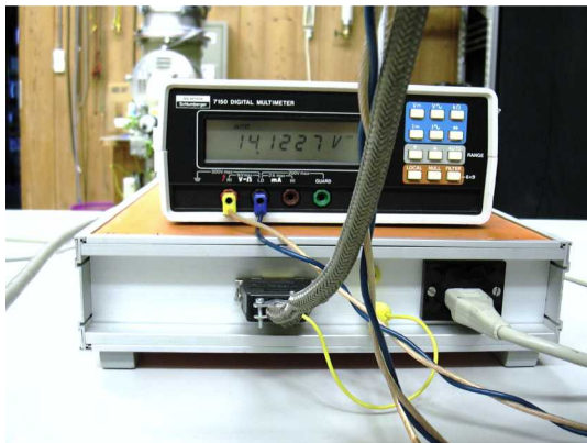
Abbildung 5: Netzgerät für die Ulbrichtkugel ( Netzgeraet.jpeg ); Schrittmotoren-Controller mit 15-V-Netzgerät für die Elektronik und 28-V-Netzgerät für die Motoren ( Controller1.jpeg , Controller2.jpeg ); Detektortreiber und Multimeter ( Multimeter1.jpeg , Multimeter2.jpeg )
